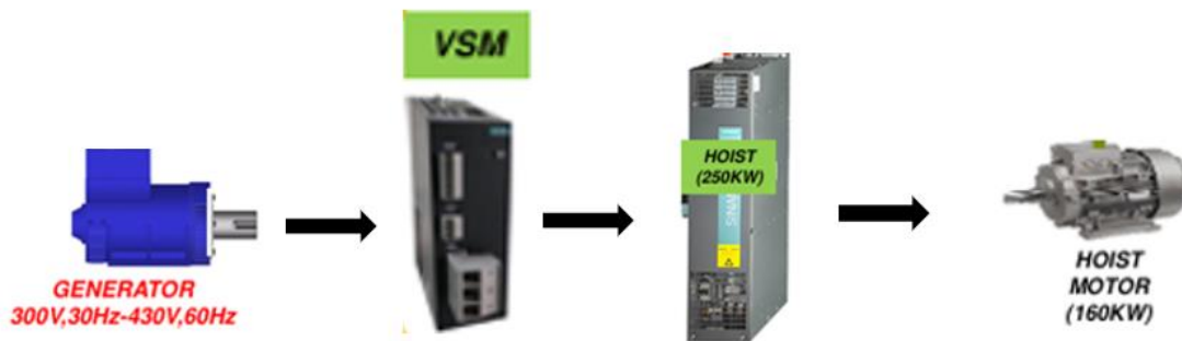
Gambar 1. Sistem Kerja Pada Motor Hoist 160kW
