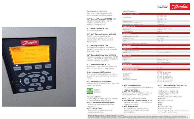
Gambar 3. (a) Bentuk Fisik VFD dan (b) Spesifikasi VFD
