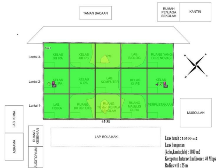
Gambar 7 Cakupan Penempatan Access Point Sampel 1 dengan Aplikasi Ekahau Site Survey
